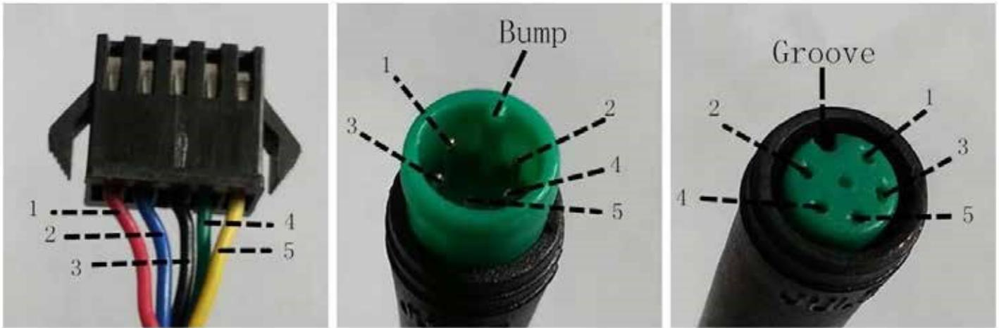
Connecteur au contrôleur bout de l'écran / File de connexion au bout de l'écran / Connector to controller display end / connection wire end to display end
