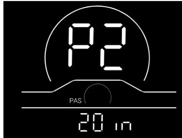
Fig. 7-2 Interface de réglage du diamètre de la roue
