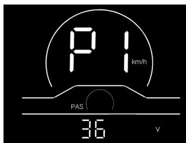
Fig. 7-1 Interface de réglage de la tension nominale
