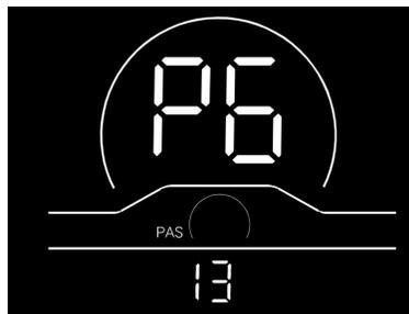
Fig. 7-6 Interface de réglage de la limite de courant
